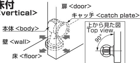
1. 本体とキャッチを図のように前後左右に動かし、取り付けに最適な位置を決めます。
