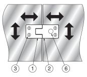
スムーズに施錠できるように、観音開き戸ロック①と 受座②がきれいに重なるようにして裏側のガラス固定 ねじ③をゆるめて調整してください。上下に2 mm、 左右に 1 mm 調整できます。次にクリアバンパー BS-12⑥を受座の後に貼ってください。
