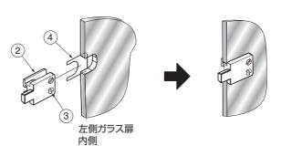
パッキン4をガラス扉のキャビネット外側にくるよう に受座②に差し込みます。次にガラス扉を観音開き戸 ロック①に差し込み、ガラス固定ねじ③を締めます。
