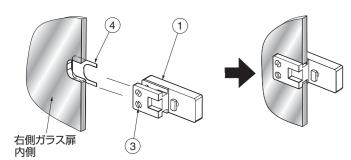
パッキン4をガラス扉のキャビネット外側にくるよう に観音開き戸ロック①に差し込みます。ガラス扉を観 音開き戸ロックに差し込み、ガラス固定ねじ③を締め
