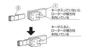
キー⑤を上図のように溝に入れます。キーを差し込む とローターが回転し、上図のようになることを確認し てください。キーを抜くとローターが縦、キーを差し 込むとローターが横になります。
